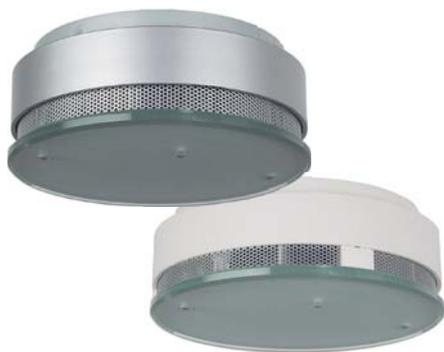
Ein Rauchwarnmelder sichert eine Fläche von rund 60 Quadratmetern bei einer Montagehöhe von bis zu sechs Metern.
